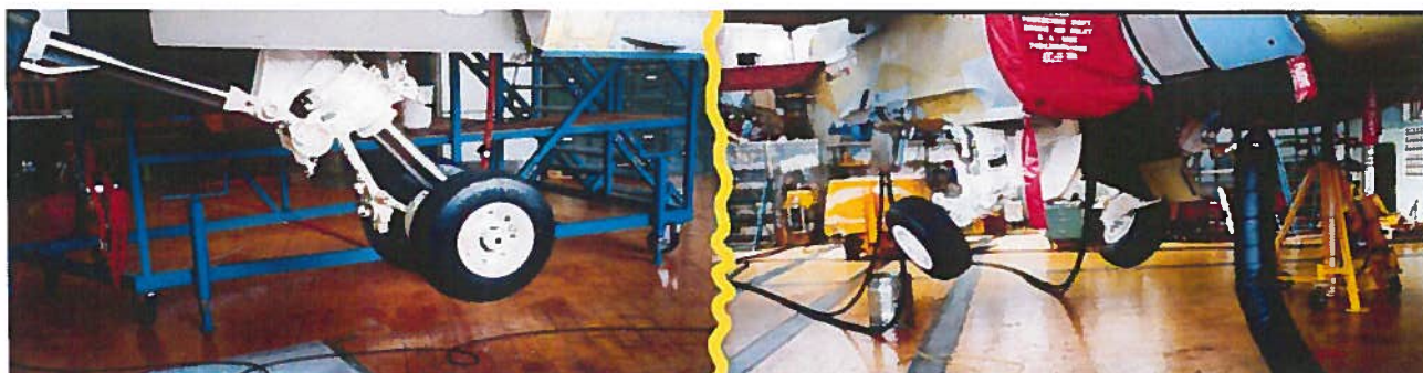
Figura 5 - NLG - MLG prova estensione - retrazione (1996 - Emmen CH)
