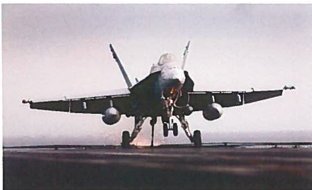
F/A 18 in appontaggio: notare i carrelli ancora scarichi, completamente estesi, il gancio di arresto del velivolo (tailhook) che ha intercettato uno dei quattro cavi (arresting gear) tesi sul ponte della portaerei
