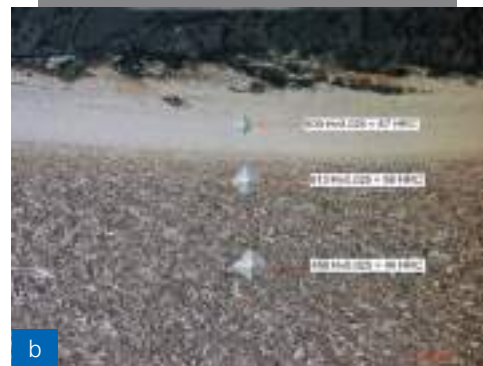
Fig. A - L’analisi ha evidenziato la formazione di micro-cricche e di danneggiamenti plastici della superficie con durezza superiori ai valori normali
