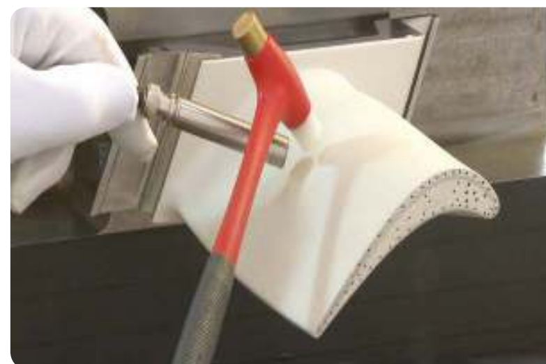
Esempio di controllo non distruttivo eseguito su palette turbogas
